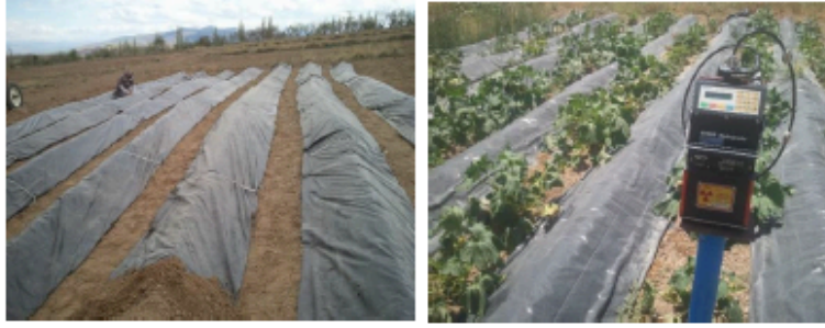
Şekil 1. Denemede kullanılan sırt-karık mikro havza yağmur suyu hasat tekniği ve toprak nemi ölçümü
